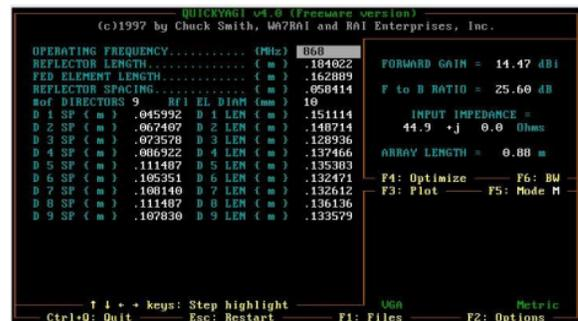
Gambar 5. Desain Antena Yagi
