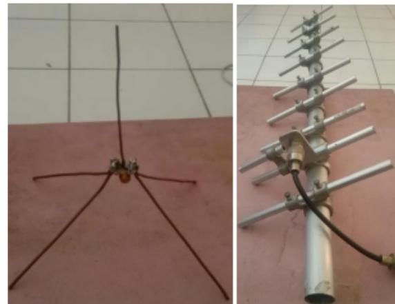
Gambar 6. Antena Ground Plane dan Antena Yagi
