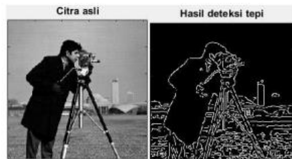
Gambar 5. Hasil Deteksi Tepi Menggunakan Algoritma Canny[3]
