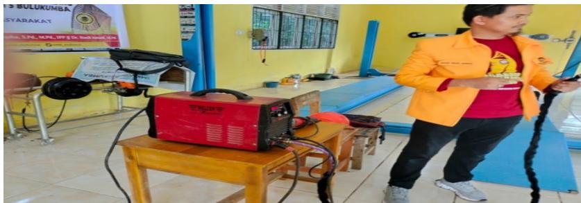
Gambar 2. Mesin las TIG yang digunakan
